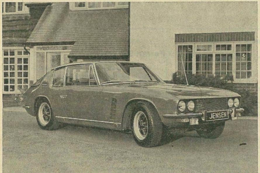
**Interceptor II auf breiteren Reifen** — Obwohl die Änderungen im Innern mit neuer Sitzgestaltung und verbesserter Instrumentenanordnung sichtbarer zutage treten, sind die grösser dimensionierten Radialreifen, die Stossstangengummipuffer, die serienmässige Servolenkung und all die Fahrgestellmodifikationen keineswegs zu verachten.
